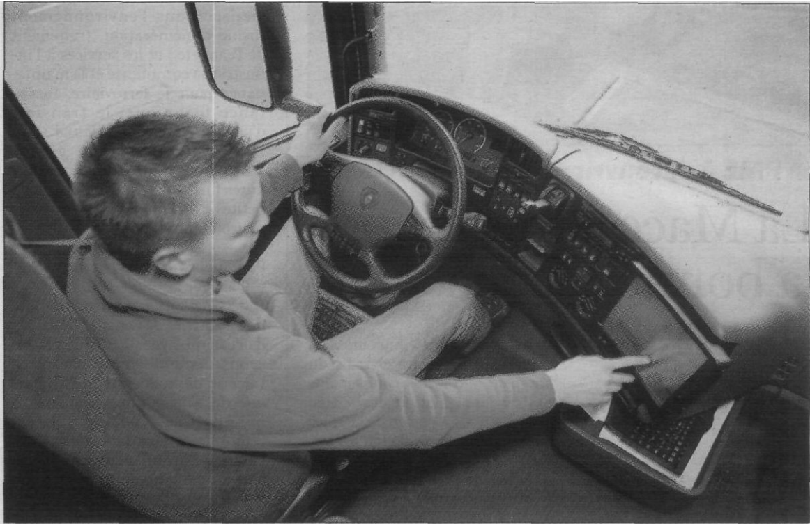
Un boîtier « M2M » (ici dans un camion Scania) optimise la communication entre une flotte de véhicules et le siège de l'entreprise.
